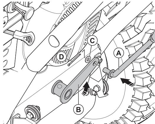
Установите на снегоуборочной машине в отверстие коннектора (B) тягу (A) и закрепите, используйте крепежные элементы - №8: (C) шайба - 1 шт.; (D) шплинт - 1 шт.
