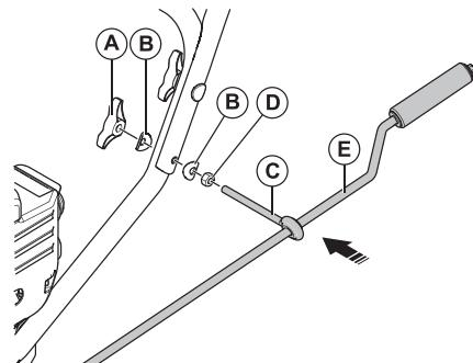
Присоедините рукоятку поворотного желоба к нижней ручке при помощи крепежа - бокс № 6: (A) барашковая гайка M8 – 1 шт.; (B) фигурная шайба – 2 шт.; (D) гайка M8 – 1 шт.
